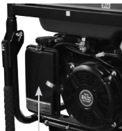
Luchtfilter voor modellen KS 12-1E ATSR, KS 12-1E 1/3 ATSR.
